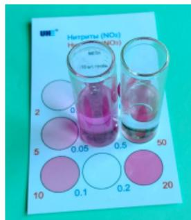
После проведения теста тщательно промойте кюветы водопроводной водой, затем ополосните их дистиллированной водой (например - **UHE distilled water**). Вытрите кюветы насухо чистой салфеткой.
